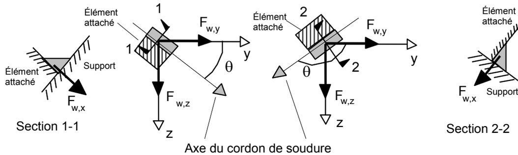
**Les composantes de sollicitation par unité de longueur de cordon au point critique de la soudure sont déterminées dans une annexe à la fin de cet exemple.**
