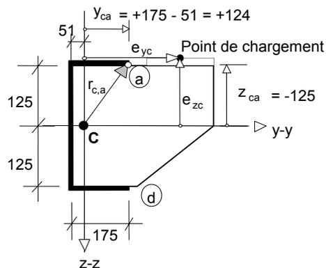
Les coordonnées du point critique de l'assemblage, (a), par rapport aux axes principaux qui passent par le centre de gravité (C) sont :
